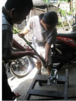
Gambar 3. Proses Pengerolan dengan cara manual
