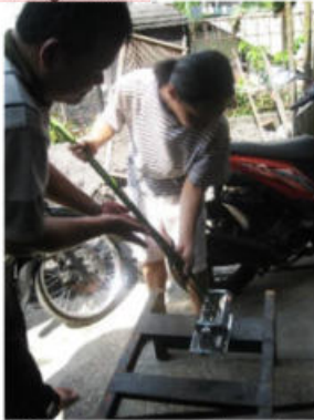
Gambar 3. Proses Pengerolan dengan cara manual
