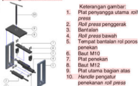
Gambar 7 Proses Perakitan Roll Press
