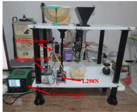
Gambar. 8. Mesin singulasi benih kedelai disk vertikal tampak samping.
