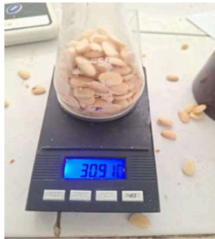
Gambar 2: Pengukuran masa dan volume butiran kedelai matang
