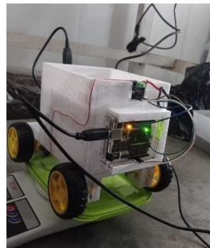
Gambar 4. Mobile robot tampak belakang dengan Arduino Uno
