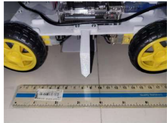
Gambar 6. Pointer menunjuk posisi robot berhenti pada 8,5 cm.
