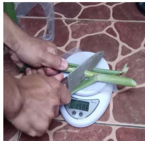
Gambar 3. Analisis gaya potong untuk 1 rumput menggunakan timbangan
