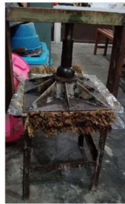
Gambar 5. Pengepresan lamina dengan alat press
