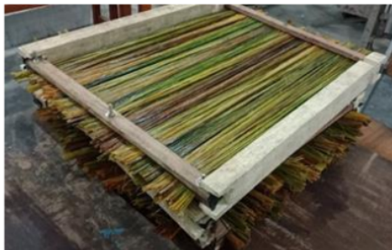
Gambar 4. Serat yang telah dialkalisasi dipersiapkan untuk dijemur
