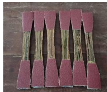
Gambar 6. Spesimen uji tarik Pengujian tarik
