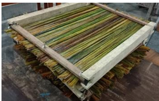
Gambar 4. Serat yang telah dialkalisasi dipersiapkan untuk dijemur
