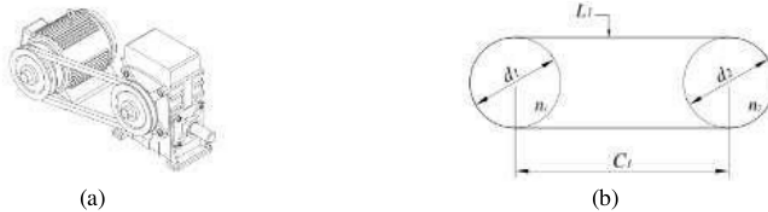
Gambar 5. (a) Transmisi Motor Penggerak – Gearbox, (b) Parameter Transmisi Motor Penggerak - Gearbox
