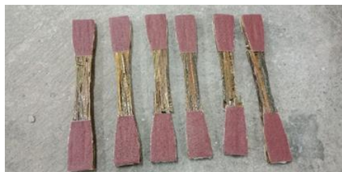
Gambar 48. Spesimen 1 jam (B) setelah pengujian (Dokumentasi Pribadi)
