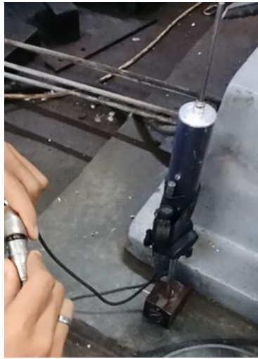
Gambar 33. LVDT (Dokumentasi Pribadi)
