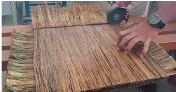
Gambar 37. Pemotongan komposit serat (Dokumentasi Pribadi)
