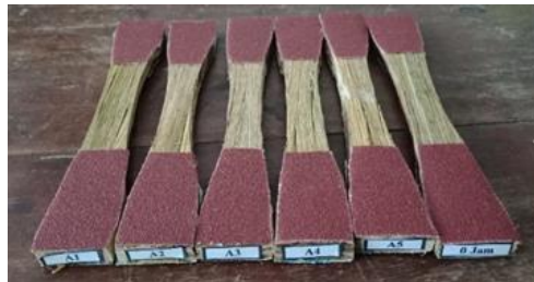
Gambar 45. Spesimen Variasi 0 jam (A) sebelum pengujian (Dokumentasi Pribadi)
