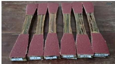
Gambar 49. Spesimen 2 jam (C) sebelum pengujian (Dokumentasi Pribadi)
