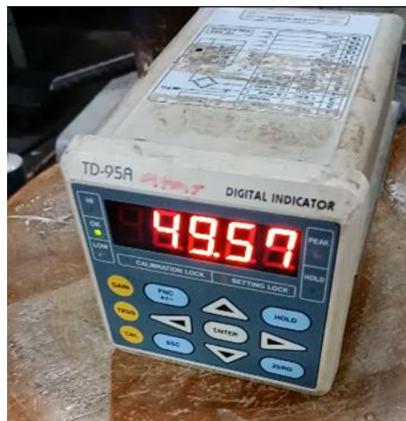
Gambar 34. Displacement meter (Dokumentasi Pribadi)
