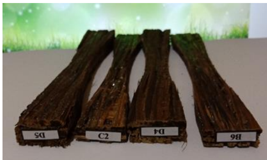
Gambar 38. Spesimen uji tarik (Dokumentasi Pribadi)
