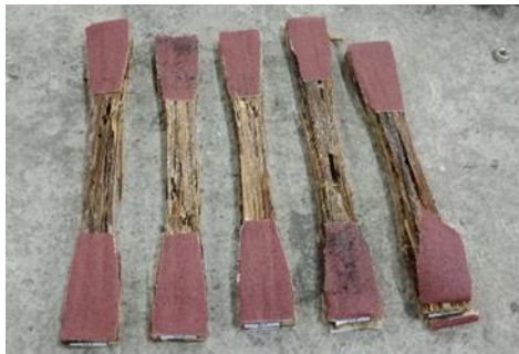
Gambar 52. Spesimen 3 jam (D) setelah pengujian (Dokumentasi Pribadi)
