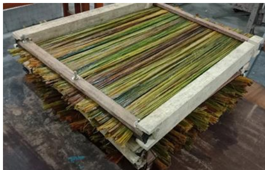
Gambar 35. Penyusunan serat pada kayu penjepit (Dokumentasi Pribadi)
