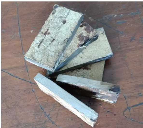
Gambar 29. Pelat pembatas ketebalan (5 mm) (Dokumentasi Pribadi)
