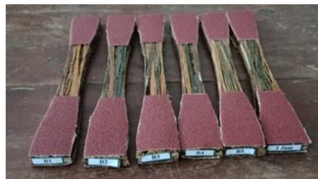
Gambar 47. Spesimen 1 jam (B) sebelum pengujian (Dokumentasi Pribadi)
